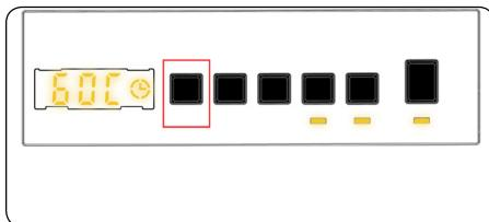
Pri výbere programu sa automaticky vyberie maximálna teplota daného programu. Ak chcete nastaviť teplotu, stlačte tlačidlo na nastavenie teploty vody, pokým sa na digitálnom displeji nezobrazí požadovaná teplota.
