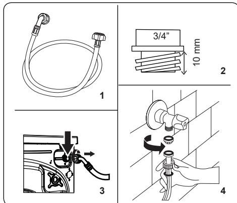
1. Váš spotrebič má jedno zapojenie prívodu vody (studená) alebo dvojité zapojenie prívodu vody (horúca a studená) v závislosti od parametrov spotrebiča. Hadica s bielym označením sa pripája k prívodu studenej vody a hadica k červeným označením s prívodom teplej vody (ak je to možné).
