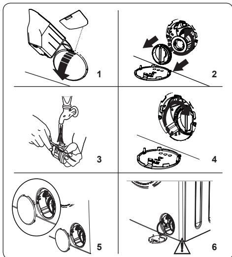
Filtračný systém čerpadla práčky predlžuje životnosť čerpadla zabránením vnikania žmolkov do spotrebiča.
