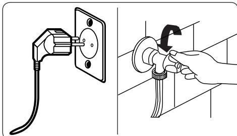
Pred vykonávaním údržby a čistenia spotrebiča vypnite sieťové napájanie a zástrčku vytiahnite zo zásuvky.
