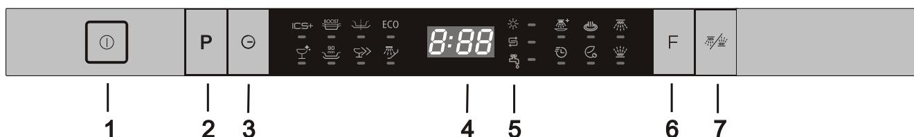
1. Tlačidlo napájania - Stlačením zapnete a vypniete. ①
