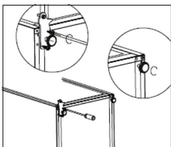
7. Nasaděte dvířka zpět. Před utažením horního závěsu se ujistěte, zda jsou dvířka vodorovně a svisle zarovnána, aby těsnění na všech stranách doléhala. Potom vložte závěs a přišroubujte jej na horní část spotřebiče.
