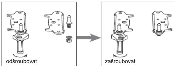
6. Přesuňte spodní závěs zleva doprava. Namontujte zpět dvě nastavitelné nožičky.
